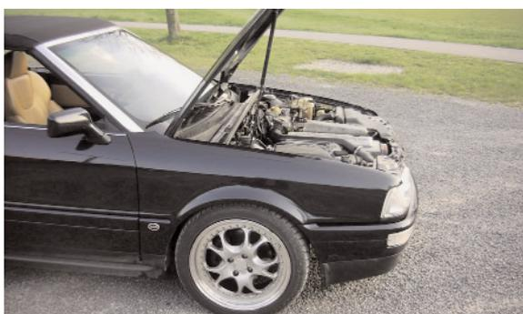
**gmg** Motorumbau, Basis 2.3l (133PS) auf 2.2l 5 Zylinder Turbo (230PS)
