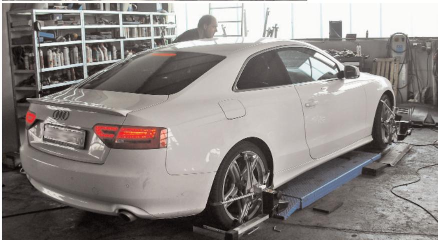
**Achsvermessung - Gradaus richtig** Das Überfahren von Schlaglöchern, das Prallen an Bordsteinen oder einfach die Ermüdung von Fahrwerksbauteilen können die Fahrwerksgeometrie leicht verstellen. Als Folge fährt Ihr Wagen nicht in der Spur, zieht nach rechts oder links und die Reifen können sich einseitig abfahren.
