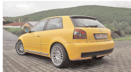
**YELLOW LIGHTNING** - S3 1.8T mit Gewindefahrwerk, Edelstahlabgasanlage, VA: 8,5x 225/40 ZR18, HA: 9,5 x 255/35 ZR 18 und Schuboptimierung
