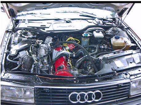
**gmg** Umbau auf Fünfzylinder 20V (MKB: 3B) Motronik
