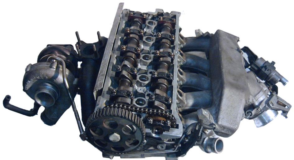
**Fünfzylinder-Benziner mit Vierventiltechnik, Abgas-Turboaufladung und Katalysator (S-Motor)** - Mit zwei Katalysatoren, Vierventiltechnik, geschlossenem Tankentlüftungssystem und Diagnose-system ist dieses Aggregat auf einem sehr hohen Stand der Abgasreinigung und -technik.
