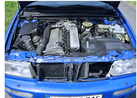
**gmg** Motorumbau: größerer Turbolader K27, 100 Zeller Kat, Edelstahl Sportabgasanlage
