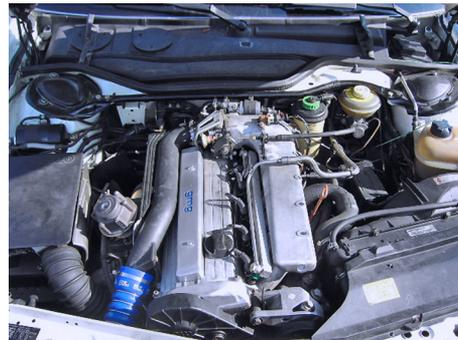
**gmg** Motorumbau: RS2 Technik, verstärkte Pleuellager und Schläuche
