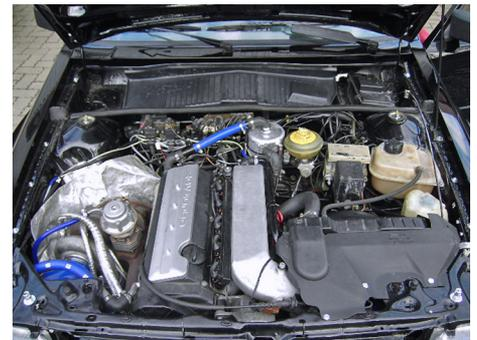
**gmg** Motorumbau: Umbau Einzelzündung, S1 Abgaskrümmen, Garrett GT35, Zylinderkopfbearb., verstärkte Pleuel, Verdichtungsred., kurze Ansaugbrücke.....
