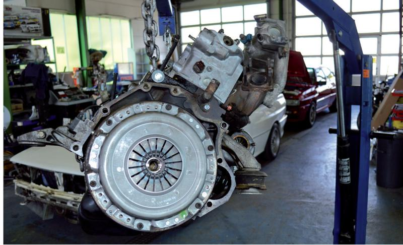
Für den Biturbo kommt erstmalig bei Audi eine SAC (Self-Adjusting - Clutch, eine selbstnachstellende Kupplung) Kupplungsruckplatte mit Verschleißnachstellung zum Einsatz
