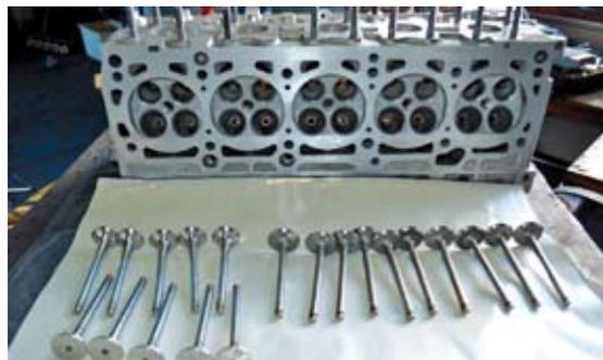
**Kopfarbeit -** Zylinderkopfinstandsetzung, schweißen, schleifen, Ventilsitze fräsen und Ventilfehrungen erneuern
